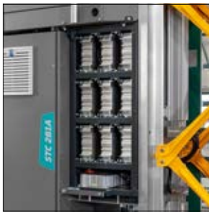
Höchste Effizienz dank Speicherung der Bremsenergie in SuperCaps
