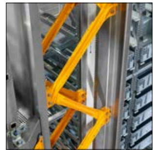
Energieeffiziente Leichtbauweise mit Aluminium-Extrusionsprofilen
