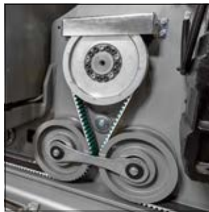
Im Mastfuß integrierter Omega-Fahrantrieb für minimale Anfahrmaße
