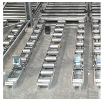
Durch die dreigeteilte Konstruktion mit einer Auslaufhöhe von ca. 66 mm gewährleistet der Bodenauslauf eine sanfte Palettenentnahme.
